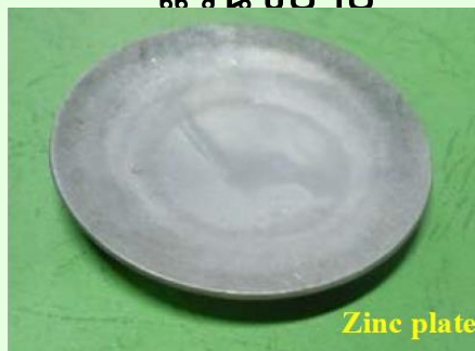
แผ่นสังกะสีรูปกระจากนาฬิกาใช้ทดสอบแร่ดีบุก
