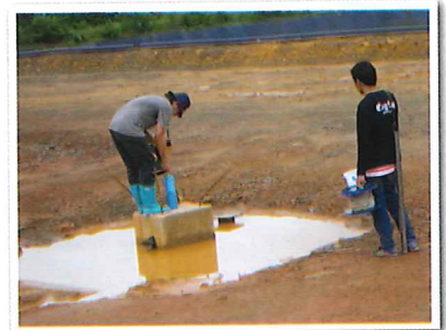
การเก็บตัวอย่างน้ำใต้ดินในพื้นที่โครงการ
