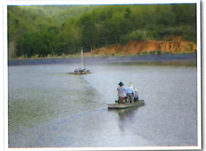
การเก็บตัวอย่างตะกอนกากแร่
