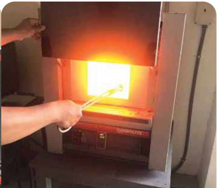
การทดลองเผาตัวอย่างเพอร์ไลต์เพื่อหาความสัมพันธ์ระหว่างอุณหภูมิที่เผา เวลาในการเผา และการขยายของอุณหภูมิแร่เพอร์ไลต์ในห้องปฏิบัติการ
