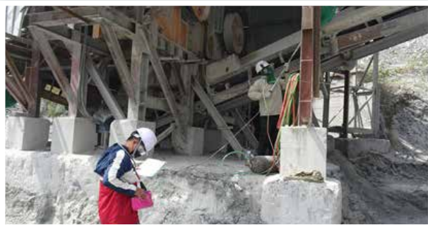
ตรวจวัดปริมาณฝุ่นละอองที่จุดกำเนิดฝุ่นของโรงโม่ บด หรือย่อยหิน ด้วยการตรวจวัดค่าความทึบแสง (Smoke Opacity Meter) ในพื้นที่ตำบลห้วยกะปิ และตำบลหนองช้างคอก อำเภอเมือง จังหวัดชลบุรี วันที่ 21 - 26 มีนาคม 2565
