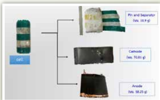
องค์ประกอบของเซลล์ (Cell) จำนวน 1 เซลล์
