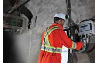
สถานีรายงานคุณภาพอากาศในเหมืองใต้ดิน (AQS air quality monitoring station) ติดตั้งโดย MAESTRO DIGITAL MINE ประเทศแคนาดา (“Key Considerations for Planning a Ventilation System on Demand,” n.d.)
