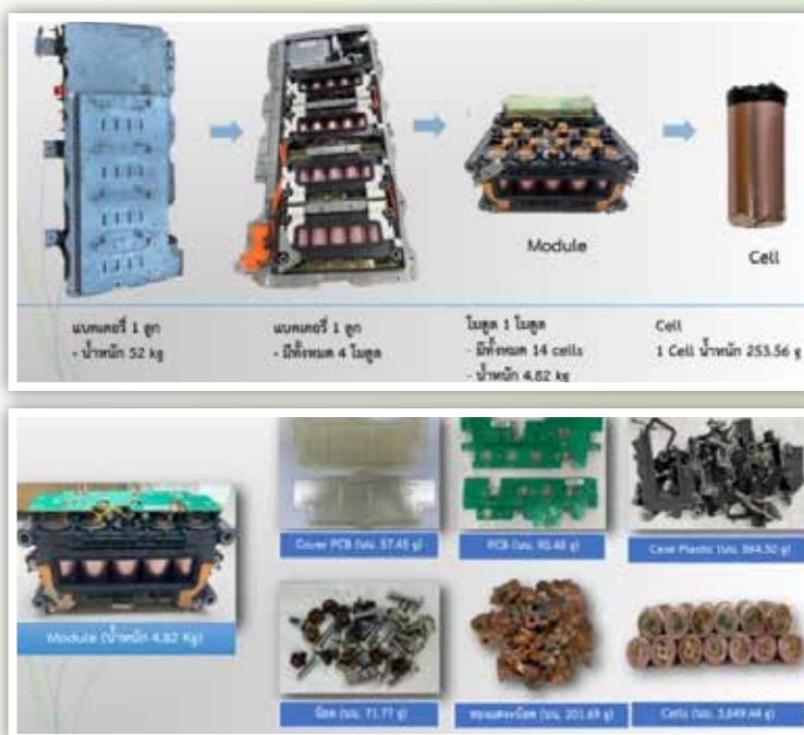
องค์ประกอบของแบตเตอรี่ยานยนต์ไฟฟ้าใช้งาน จำนวน 1 ลูก
