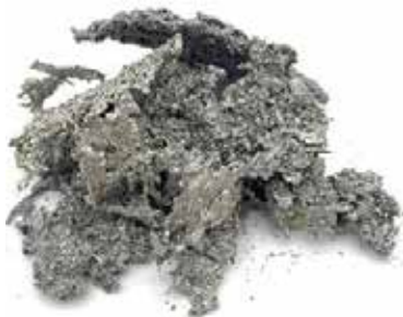
ตะกรันโลหะบัดกรี ที่มีดีบุกเป็นองค์ประกอบ
