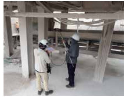
ตรวจวัดปริมาณฝุ่นละอองที่จุดกำเนิดฝุ่นของโรงโม่ บด หรือย่อยหิน ด้วยการตรวจวัดค่าความทึบแสง (Smoke Opacity Meter)
