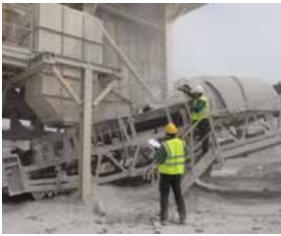
ตรวจวัดปริมาณฝุ่นละอองที่จุดกำเนิดฝุ่นของโรงโม่ บด หรือย่อยหิน ด้วยการตรวจวัดค่าความทึบแสง (Smoke Opacity Meter)
