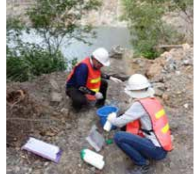
ตรวจวัดปริมาณฝุ่นละอองที่จุดกำเนิดฝุ่นของโรงโม่ บด หรือย่อยหิน ด้วยการตรวจวัดค่าความทึบแสง (Smoke Opacity Meter)
