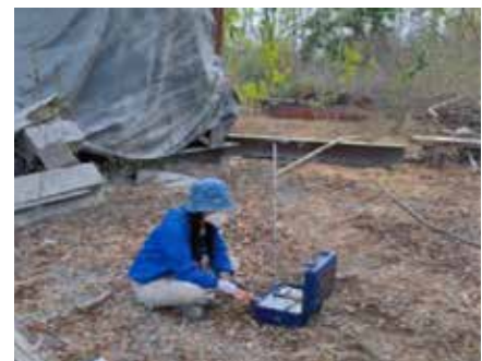
ตรวจวัดคุณภาพสิ่งแวดล้อม ตรวจวัดคุณภาพอากาศ ระดับเสียง และความสั่นสะเทือนบริเวณชุมชนโดยรอบพื้นที่เหมืองแร่ และโรงโม่ บด หรือย่อยหิน
