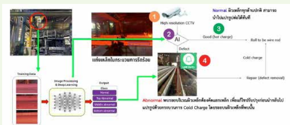
ต้นแบบระบบตรวจจับและคัดแยกคุณภาพเหล็กแท่ง ด้วย Image Processing และ Deep Learning
