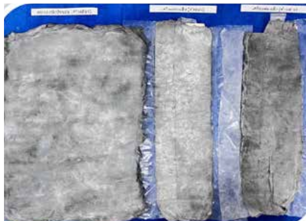
เครื่องสร้างฟุ้งของผงแบ่งทาลคัมและการทดสอบการเคลือบผิวยาง
