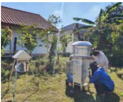
ตรวจวัดคุณภาพสิ่งแวดล้อม ตรวจวัดคุณภาพอากาศ ระดับเสียง และความสั่นสะเทือนบริเวณชุมชนโดยรอบพื้นที่เหมืองแร่ และโรงโม่ บด หรือย่อยหิน
