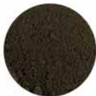
ฝุ่นสังกะสีและทองแดง จากไอของกระบวนการหลอมทองเหลือง
