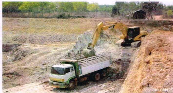
ภาพตัวอย่างการทำเหมือง (แบบขั้นบันได) และการขุดตักแร่
