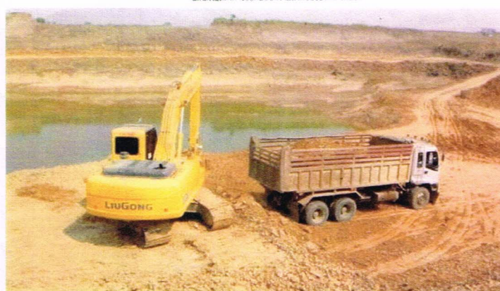
ภาพตัวอย่างการทำเหมือง (แบบขั้นบันได) และการขุดตักแร่
